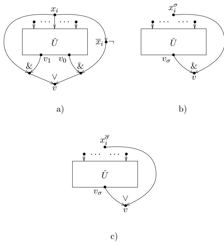
Рис. 9.2: к моделированию операций присоединения контактов в классе СФЭ
