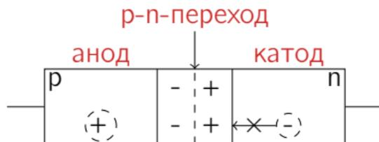
Это **полупроводниковый диод**, пропускающий ток в одну сторону и не пропускающий обратный ток:
