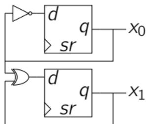
Реализация двухбитового счётчика с использованием шин и регистра:
