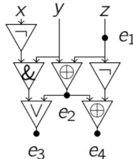
Схемой над переменными  $x, y, z$  реализуется набор функций  $(f_1, f_2, f_3, f_4) = ([z], [y \oplus z], [\neg x \& y \vee (y \oplus z)], [y \oplus z \oplus \neg z])$ :
