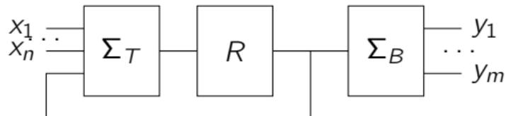
Следующая схема является типовой реализацией изображённого выше автомата  $\mathcal{A}$  схемой без входов и с одним выходом у ширины 2 для соответствия  $\varphi_O(m) = [y/m]$ :
