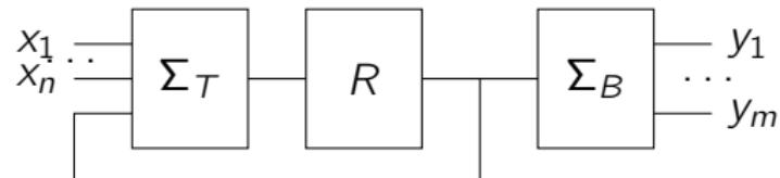
Выбирается отображение  $T'$ :  $\mathbb{Z}_{(k)} \times I' \rightarrow \mathbb{Z}_{(k)}$ , такое что  $T'(\varphi_Q(q), \varphi_I(a)) = T(q, a)$  для всех  $q \in Q$  и  $a \in I$
