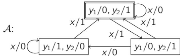
Автомат  $\mathcal{A}$  реализуется схемой  $\Sigma$  и соответствует схеме  $\Sigma$
