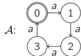
Если значения на выходах схемы в каждый момент времени **однозначно** определяются её состоянием, то функцию выхода  $B$  соответствующего автомата можно задать так:
