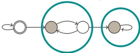
Следующий автомат Бюхи пуст (не содержит требуемых в теореме компонент сильной связности):
