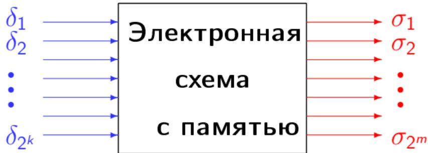
Для моделирования управляющих систем вполне подходят автоматы Мура и Миля, схемы из функциональных элементов с задержкой и пр.
