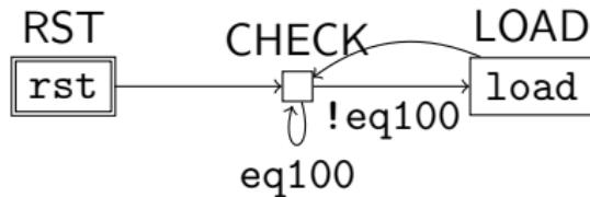
Это диаграмма Мура управляющего автомата для “сложного” счётчика  $S_2$  из *блока 17*
