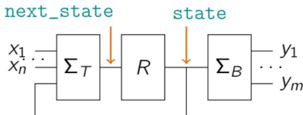
Реализуем функцию выхода ( $\Sigma_B$ ) в отдельной процедуре:
