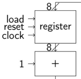
Эта схема определяет то, как преобразуются данные, то есть **операционный автомат**
