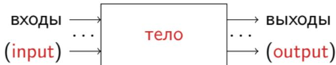
Входы и выходы (и многое другое) могут быть объединены в **массивы** (индексация с ноля; при определении задаются смещения сначала последнего, потом первого элемента: [7:0]; в остальном — как в C++)
